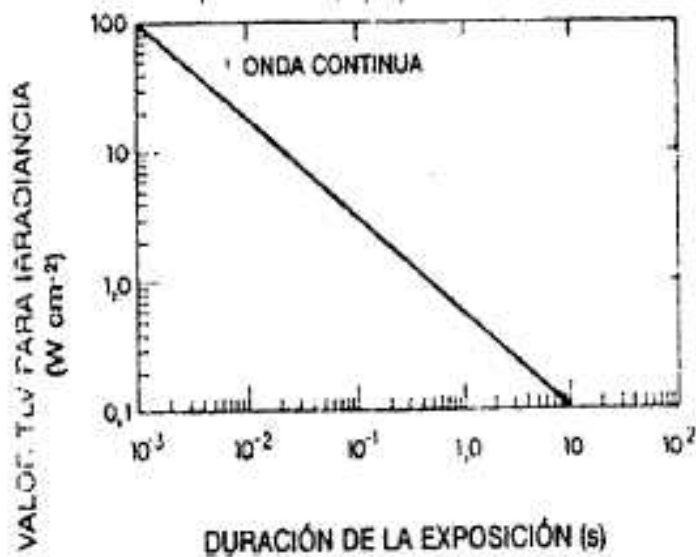
Figura 3 b. Valor TLV para exposición de la piel y los ojos a láser de onda continua para radiación infrarroja lejana. (Longitudes de onda superiores a 1,4 μm).
